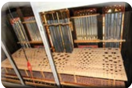
Jedes Loch nimmt eine Pfeife auf, die Luft strömt von unten rein
