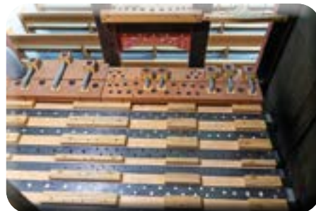
Durch Register am Spieltisch werden die Metallbänder bewegt und geben Löcher frei, durch die dann Luft strömt
